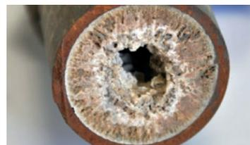
En effet, le calcaire vient se déposer sur la paroi et agrippe tous les déchets qui viennent dans la canalisation, formant ainsi petit à petit un bouchon.
